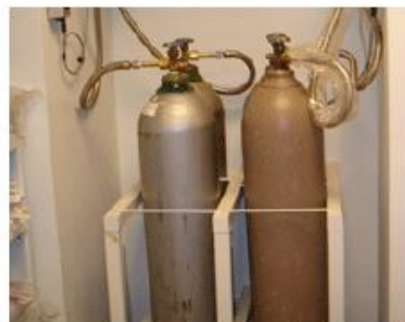
รูปที่ 2.2 ตัวอย่างการวางถังแก๊สที่เหมาะสมในห้องปฏิบัติการ (ที่มา เข้าถึงได้จาก http://blink.ucsd.edu/safety/research-lab/chemical/gas/storage.html#Basic-storage-guidelines-for-al สืบค้นเมื่อวันที่ 2 สิงหาคม 2556)
