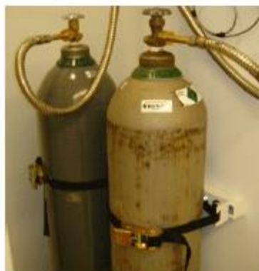
รูปที่ 2.2 ตัวอย่างการวางถังแก๊สที่เหมาะสมในห้องปฏิบัติการ (ที่มา เข้าถึงได้จาก http://blink.ucsd.edu/safety/research-lab/chemical/gas/storage.html#Basic-storage-guidelines-for-al สืบค้นเมื่อวันที่ 2 สิงหาคม 2556)
